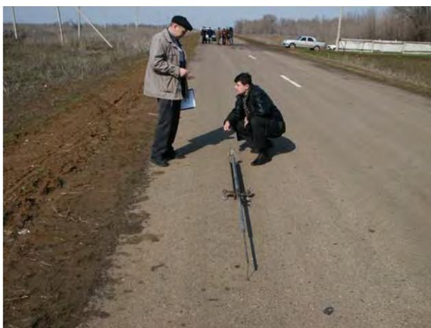
Рис. 3.19. Испытания прочности конструкций дорожной одежды на основании из грунта повышенной плотности на ПК129 + 80
