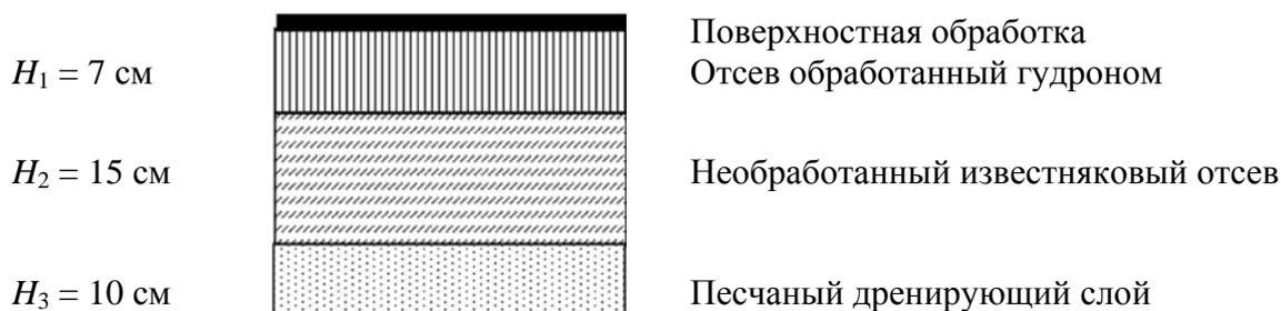
Рис. 1.5. Конструкция дорожной одежды из известнякового отсева на 2-м типе местности с песчаным дренирующим слоем
