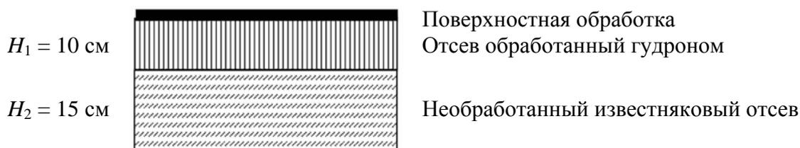
Рис. 1.3. Конструкция дорожной одежды из известнякового отсева на 1-м типе местности и супесчаном грунте земляного полотна
