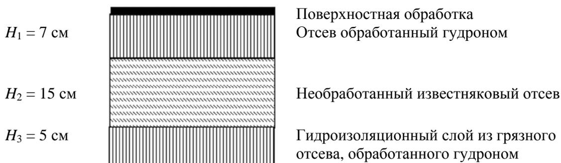
Рис. 1.4. Конструкция дорожной одежды из известнякового отсева на 2-м типе местности с гидроизоляционным слоем
