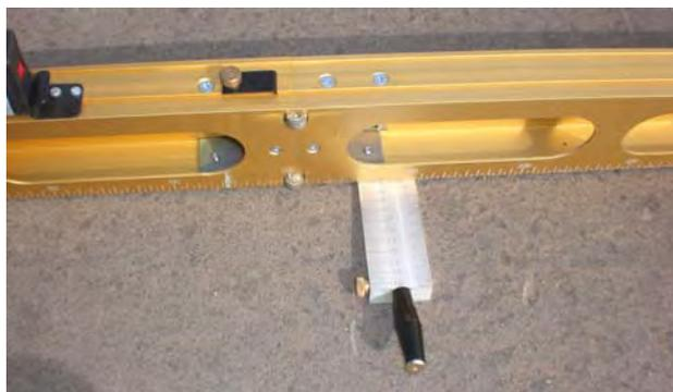
Рис. 2.13. Измерения продольной ровности покрытия рейкой
