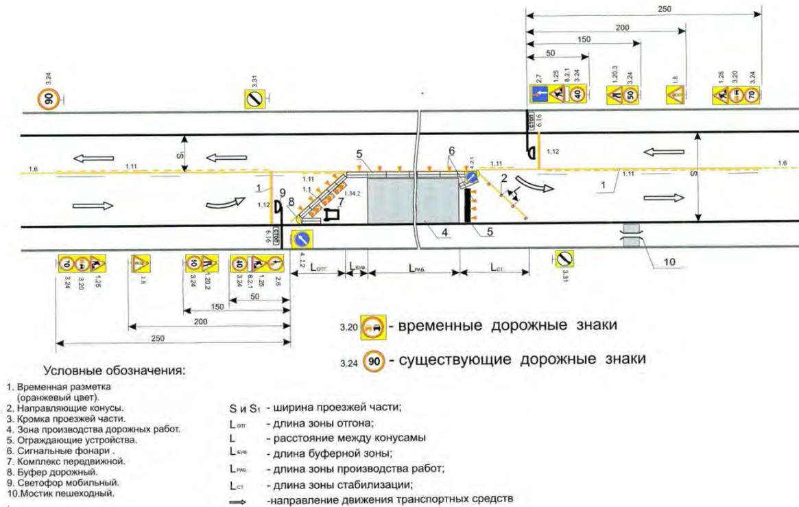
Рис. П.2.1. Пример размещения технических средств организации дорожного движения автотранспорта в местах производства дорожных работ
