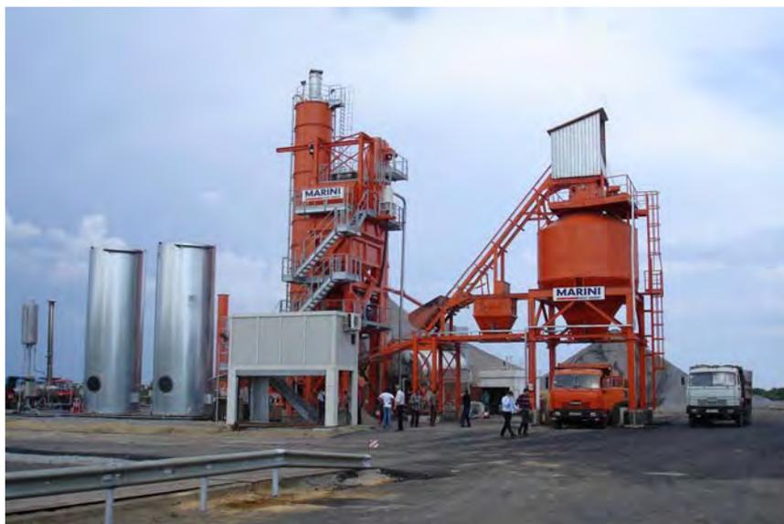
Рис. 4.9. Транспортабельный АБЗ производительностью 175 т/ч (г. Воронеж)
