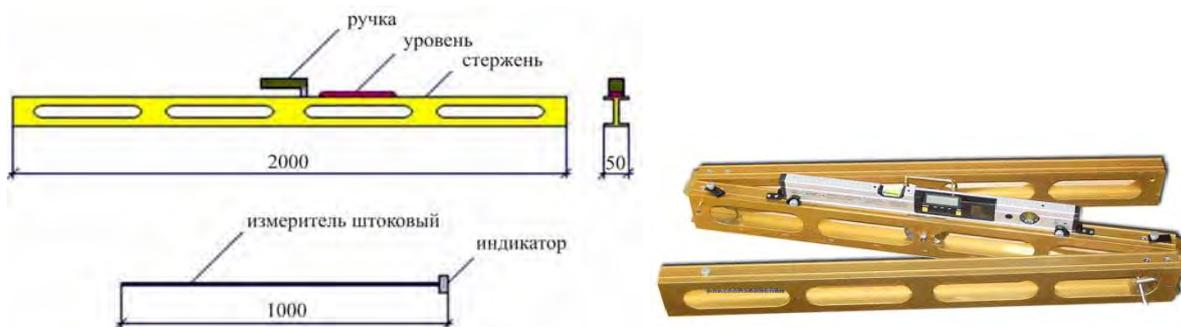
Рис. 2.10. Дорожная рейка для оценки ровности и поперечных уклонов покрытия
