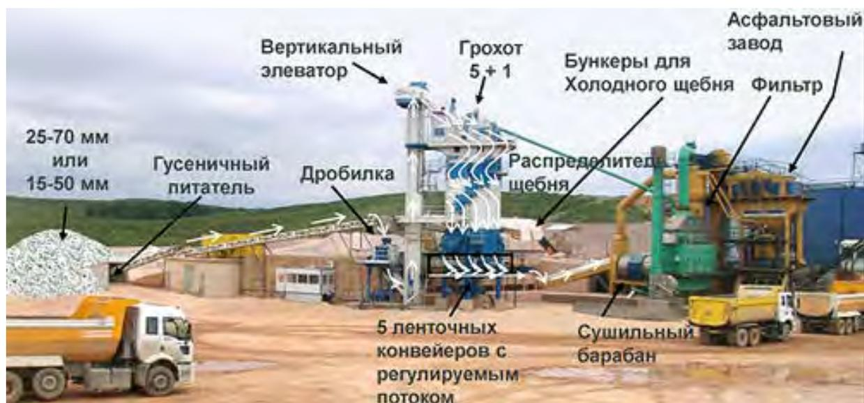
Рис. 4.12. Состав системы Simge Challenger и порядок прохождения каменных материалов
