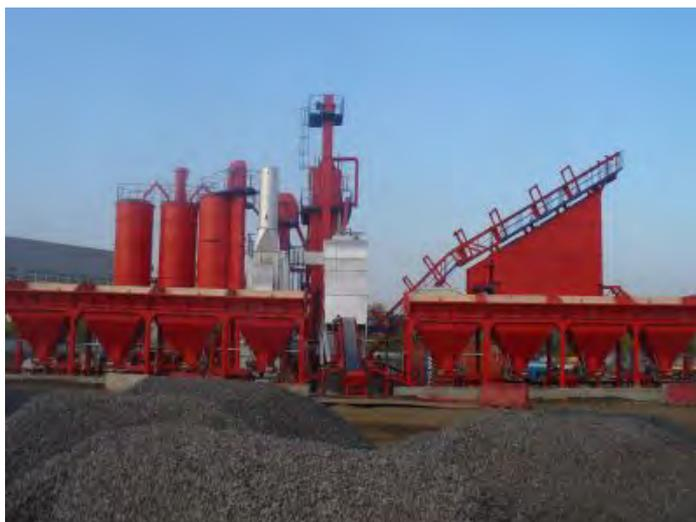
Рис. 4.7. Стационарный АБЗ циклического действия (VKM-5, VSM II, OKIPP, Словения)
