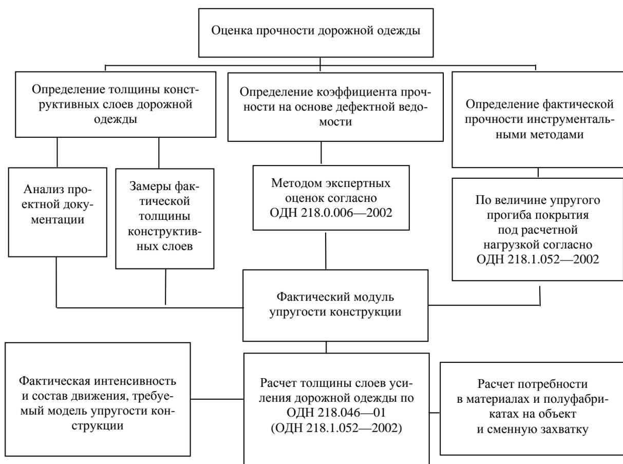
Рис. 2.15. Блок-схема расчета усиления дорожной одежды и потребности в асфальтобетонной смеси
