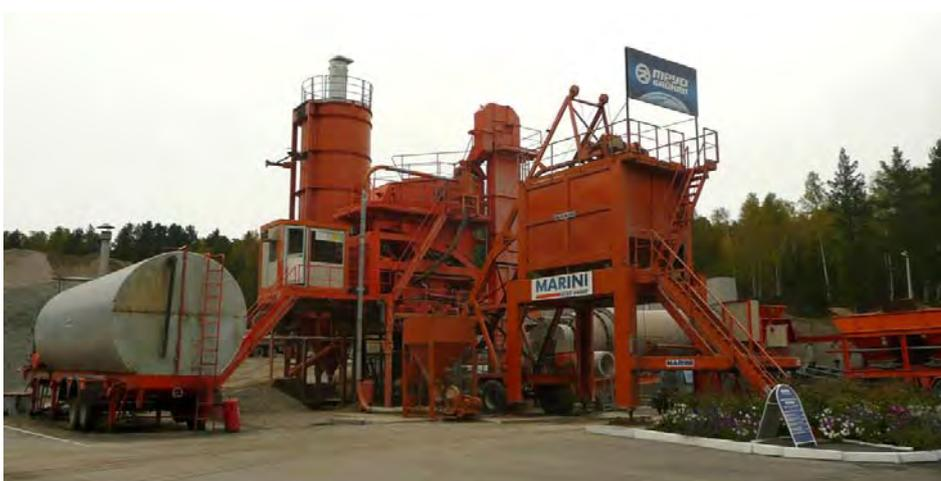
Рис. 4.8. Мобильный АБЗ производительностью 160 т/ч (г. Иркутск)
