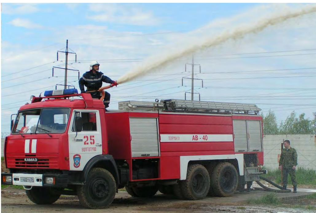
Рис. 1. Автомобиль воздушно-пенного тушения АВ-7-40
