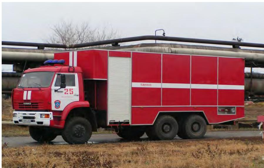
Рис. 5. Автомобиль рукавный АНР-100/3000
