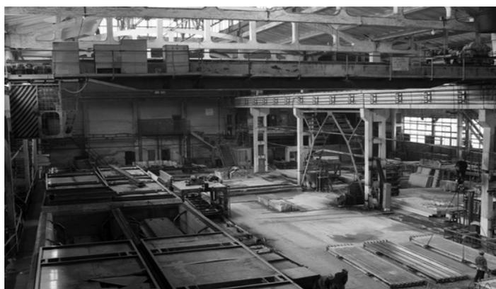
Рис. 5. Цех для производства унифицированных сборных железобетонных блоков
