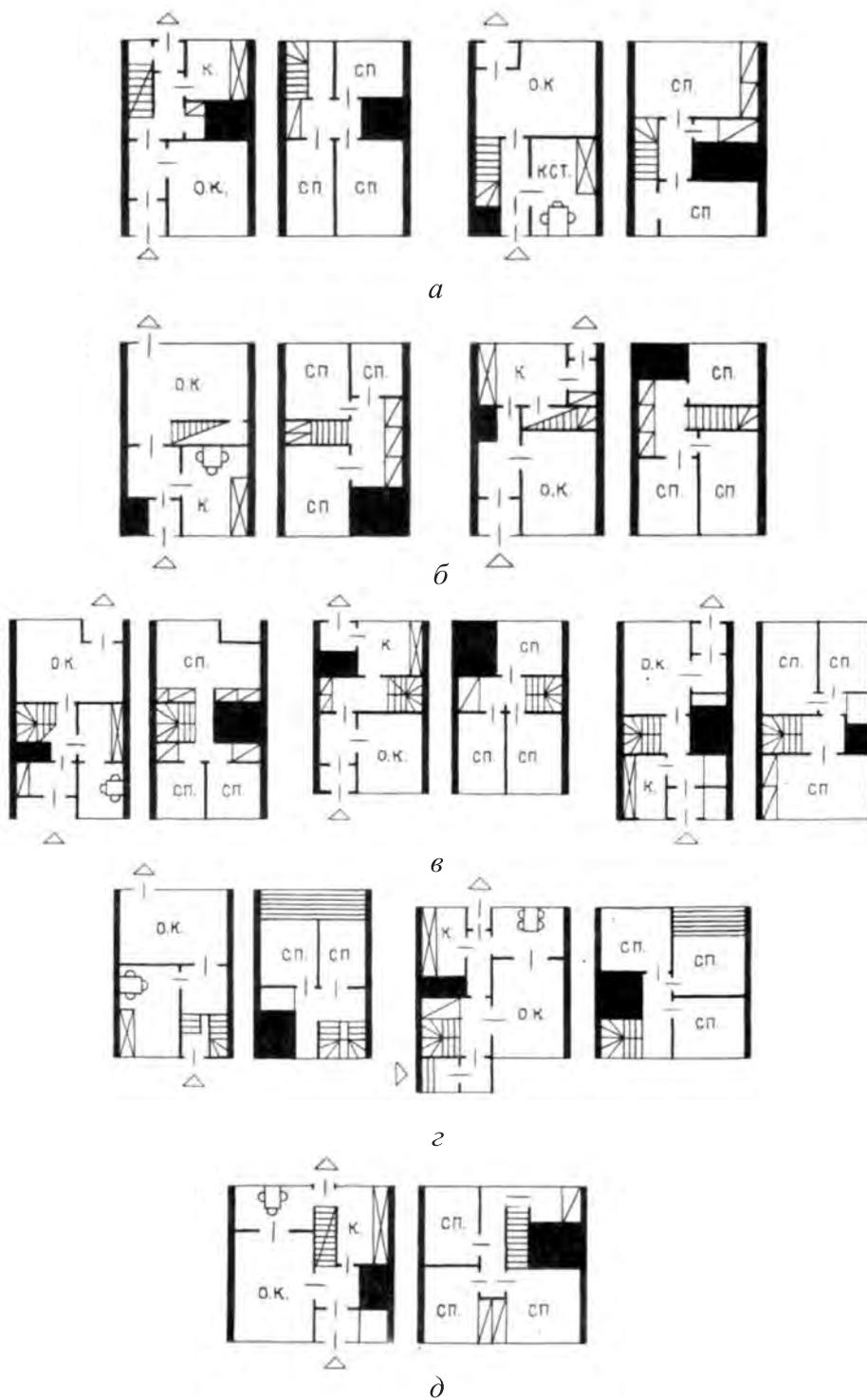
Рис. 34. Приемы расположения лестниц в блокированных домах с поперечными несущими стенами: *а* — одномаршевая—вдоль стены; *б* — перпендикулярно стене; *в* — двухмаршевая лестница в средней зоне; *г* — у входа; *д* — одномаршевая лестница в средней зоне
