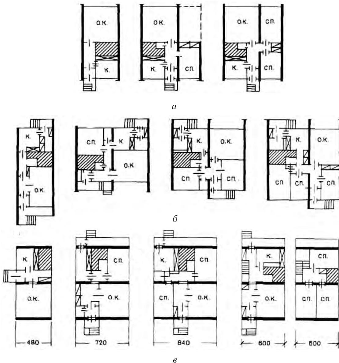
Рис. 25. Планировочные схемы серий блок-квартира:
