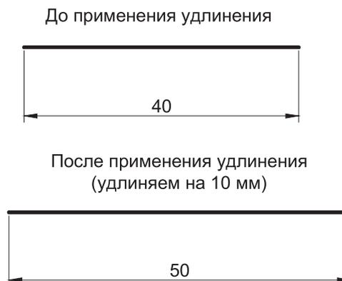
Рис. 1.5. Использование команды Удлинить (Lengthen)
