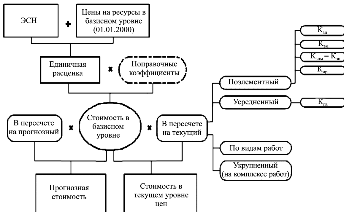
Рис. 5. Формирование сметной стоимости строительно-монтажных работ ресурсно-индексным методом
